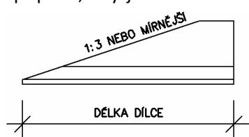
Obrázek 19 - Koncový díl betonového svodidla
