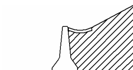
Obrázek 4 – Betonové svodidlo jako zárubní zeď
